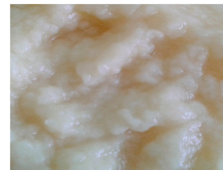
РИСУНОК 2 - СРЕДНЕ- И ГРУБОДИСПЕРСНАЯ ЦЕЛЛЮЛОЗА, ПОЛУЧЕННАЯ НА ВЫХОДЕ ИЗ ЭКСТРУЗИОННОГО АГРЕГАТА. (РАЗМЕРЫ ЧАСТИЦ ОТ 400НМ ДО 36 МКМ)
