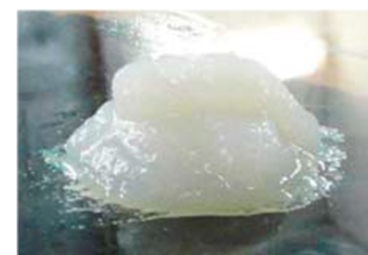
РИСУНОК 3 - НАНОФИБРИЛЛЯРНАЯ ЦЕЛЛЮЛОЗА НА ВЫХОДЕ ИЗ ГОМОГЕНИЗАТОРА ВЫСОКОГО ДАВЛЕНИЯ. (D=5-20 НМ, L=1-4 МКМ)
