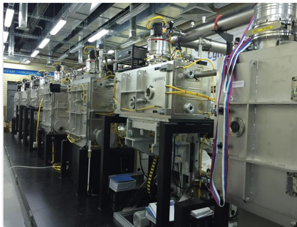
Линия из 8-ми последовательных вакуумных камер для получения ленты с буферными слоями по технологии IBAD.
