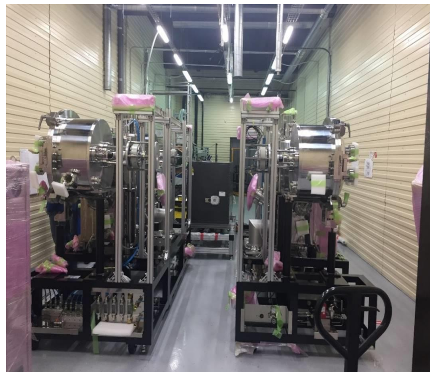
PLD-линия с Xe-Cl лазером (700 мВт/импульс, 200 Гц) для осаждения слоя ВТСП RBCuO.
