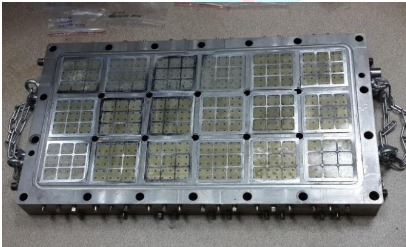
Мембранный модуль ( S = 0,12 \text{ м}^2 )
