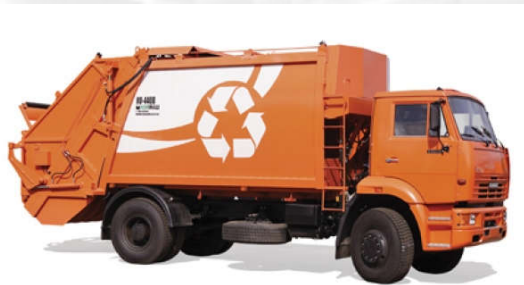
Мусоровоз для системы сбора «с несменяемыми контейнерами»
