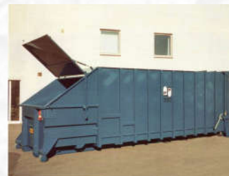
Пресс-контейнер с гидравлическим уплотнением отходов
