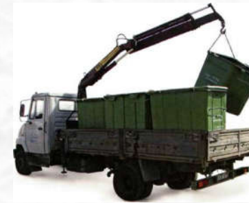
Контейнерный мусоровоз для системы сбора «со сменяемыми контейнерами»
