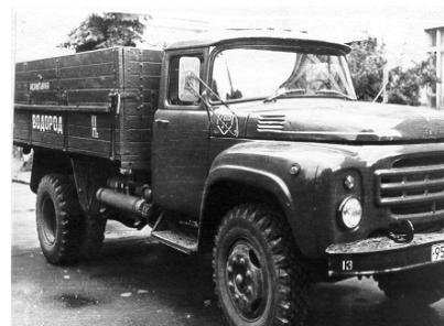
ЗИЛ-130, первый грузовой автомобиль на бензо-водородном топливе в СССР
