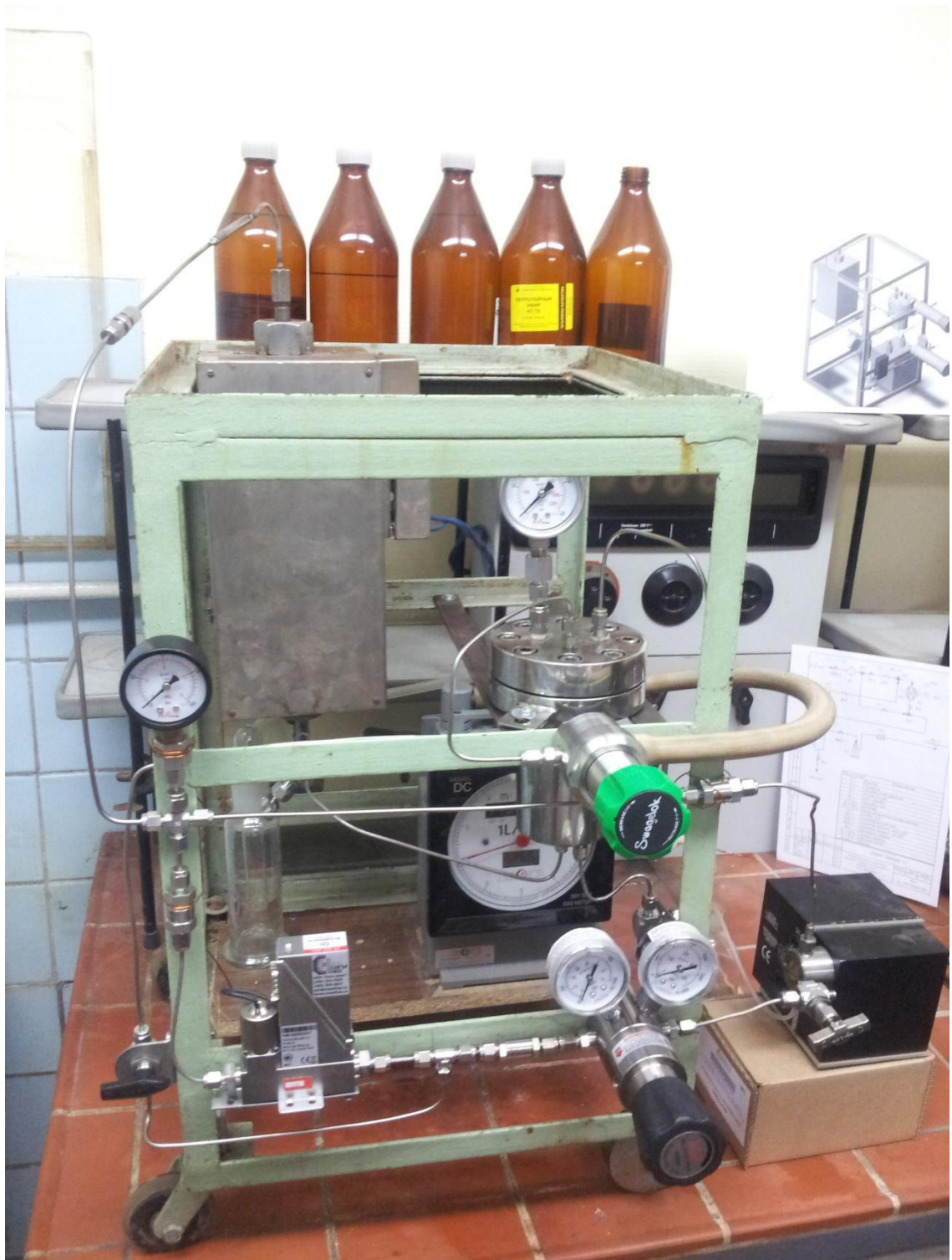
Рисунок 6.1 – Экспериментальная лабораторная установка получения моторных топлив ЭЛУПМТ.0000.000
