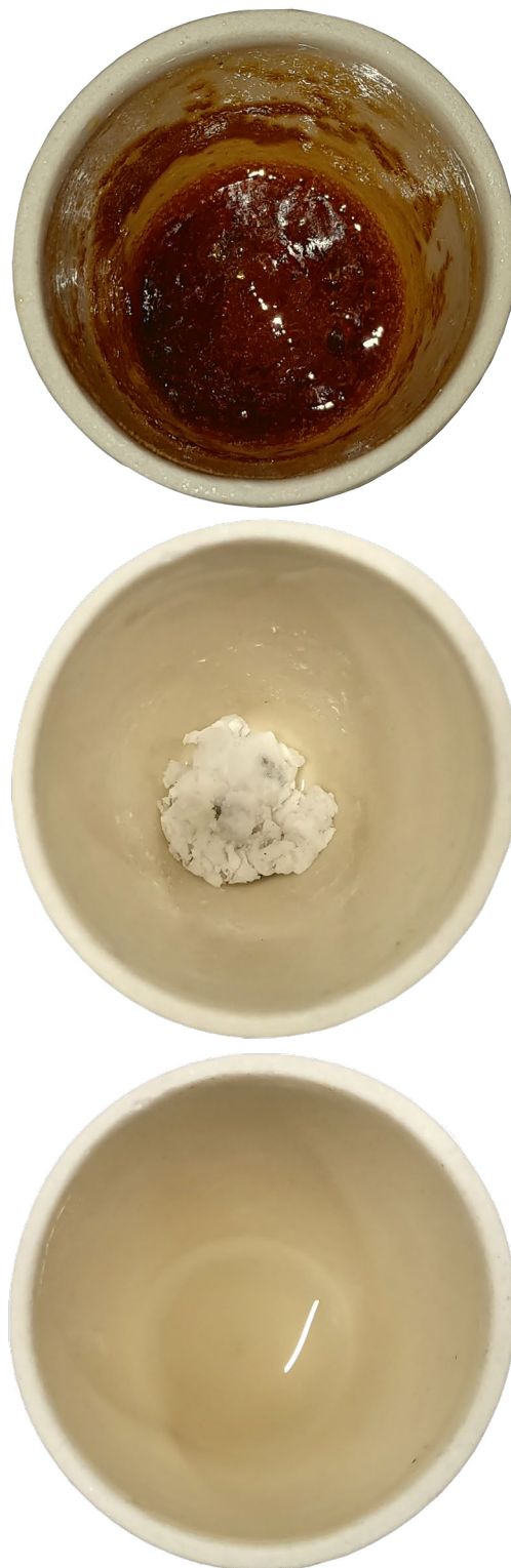
Рис. 2. Тигель с пробой после упаривания воды (сверху), озоления (по центру) и добавления соляной кислоты (снизу)
