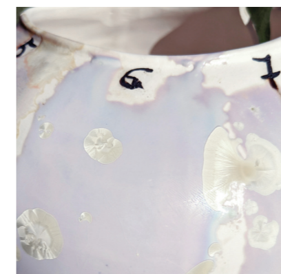
Рис. 4 – Изделие, покрытое глазурью S-0510 с введением 1,2% Sb_2O_3 (а) Пробник, покрытый глазурью S-0510 с введением 1,2% Sb_2O_3 (б)
