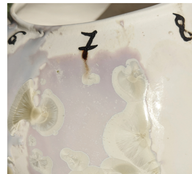
Рис. 5 – Изделие, покрытое глазурью Fr1 с введением 1,2 % Sb 2 O 3 (а) Пробник, покрытый глазурью Fr1 с введением 1,2% Sb 2 O 3 (б)
