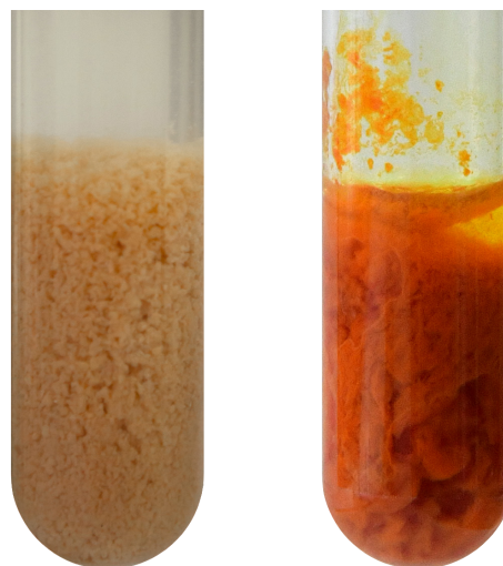
Рис. 13. Осадки соли серебра (I) с желтой (слева) и красной (справа) кровяными солями
