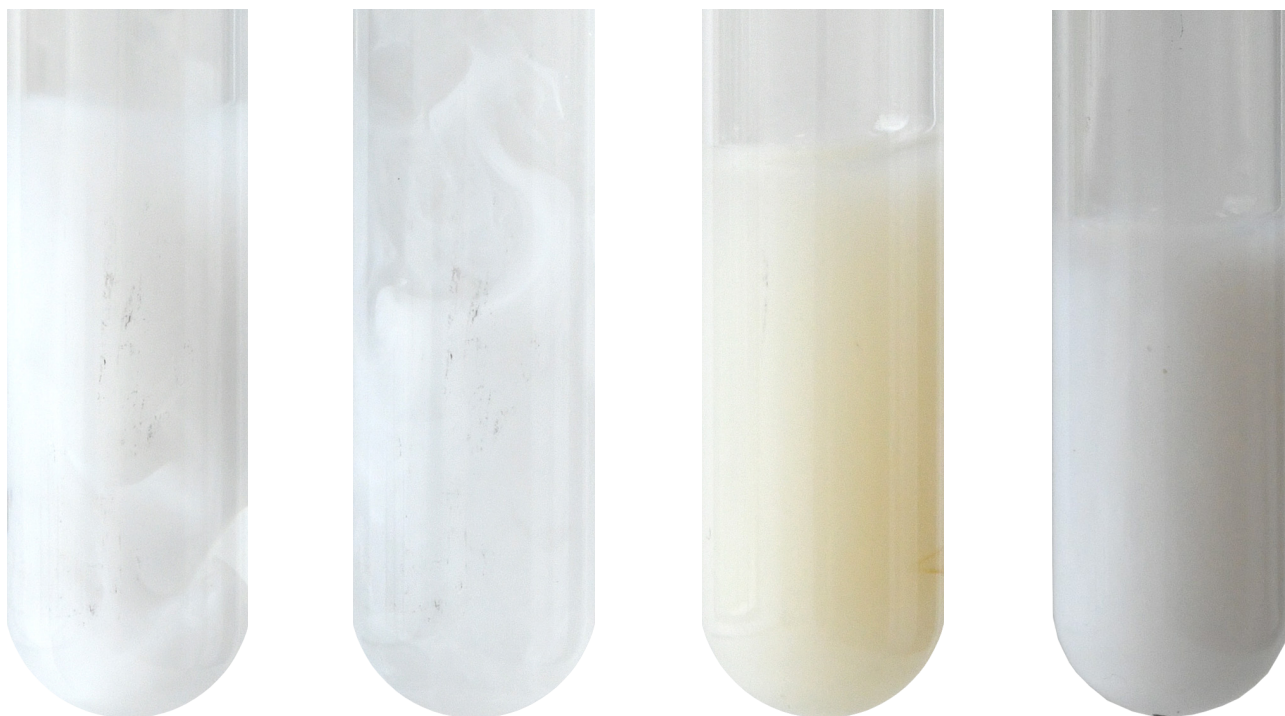
Рис. 8. Сульфит серебра (I) и его растворение в избытке сульфита натрия (слева), карбонат и сульфит серебра (I) (справа)
