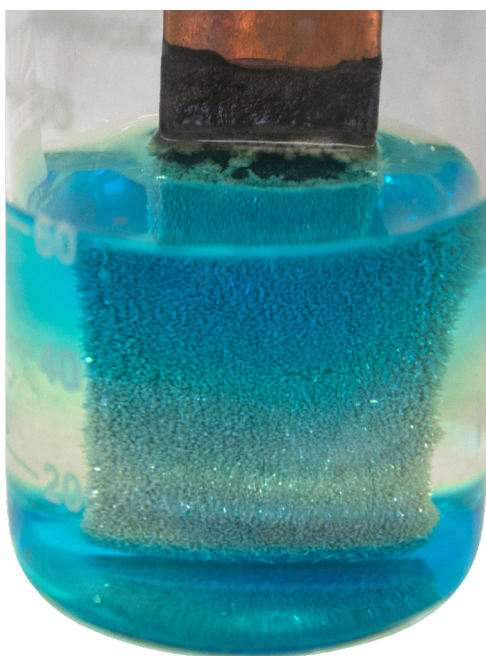
Рис. 1. Постепенный рост кристаллов серебра на медной пластинке
