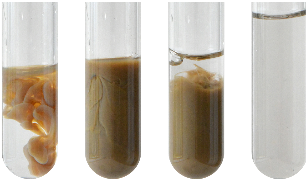
Рис. 12. Получение оксида серебра (I) и его растворение в \text{NH}_3 \cdot \text{H}_2\text{O}_{(\text{конц.})}
