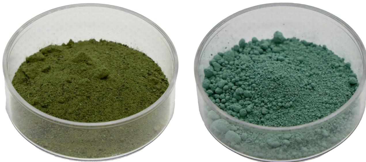
Рис. 10. Тетрахлорид (слева) и тетрафторид (справа) урана
