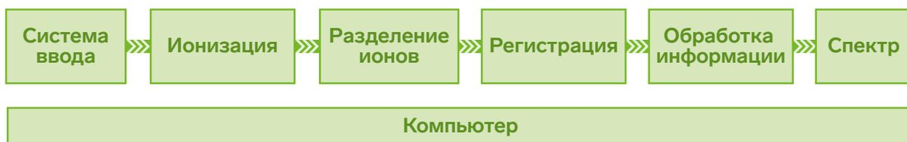
Рис. 1. Блок-схема масс-спектрометра
