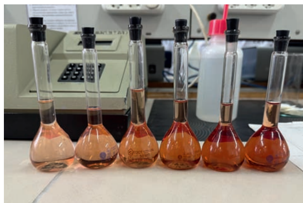
Растворы K_2[Ni(dmg)_2] с концентрацией около 10^{-5}M для фотометрического определения никеля
