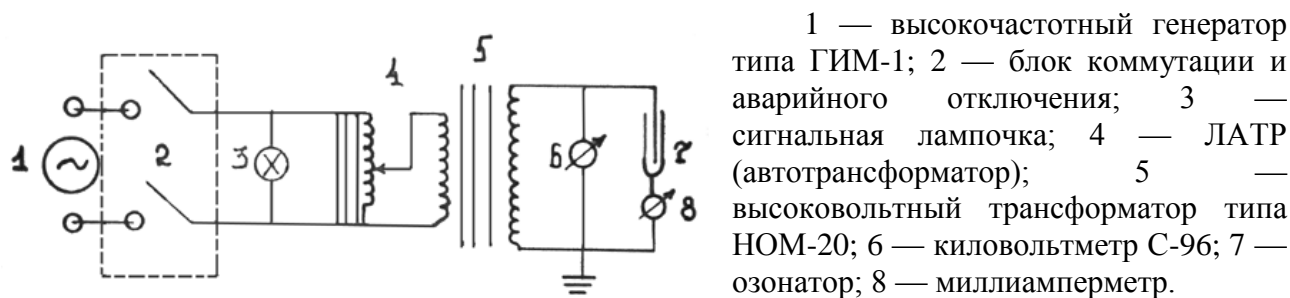
Рис. 7. Электрическая схема установки для получения концентрированного озона в барьерном разряде:
