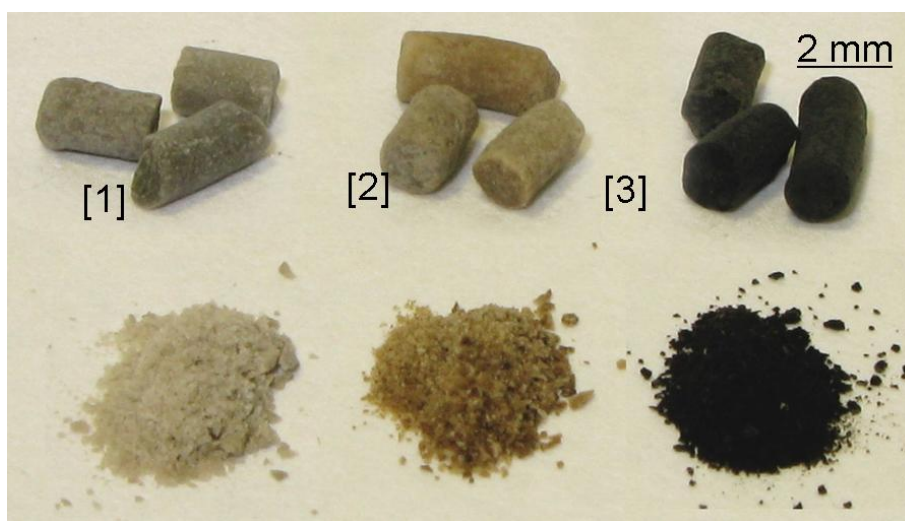
1) Исходный (свежий); 2) Закоксованный и обработанный O 3 /СК-CO 2 ; 3) Закоксованный.
