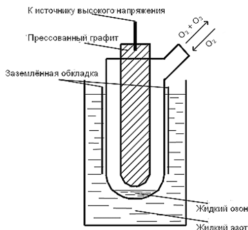
Рис. 6. Схема озонатора для получения высококонцентрированного озона.
