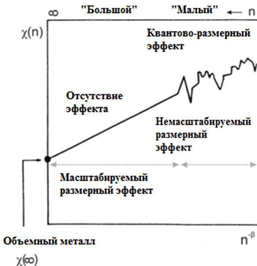
Рисунок 1.3. Изменение физической величины \chi(n) как функции размера кластера ( n – число атомов в кластере) [23].
