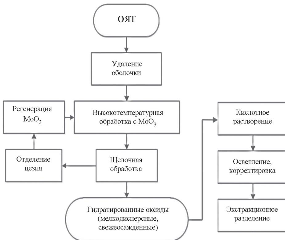
Рис. 1. Принципиальная схема процесса переработки ОЯТ
